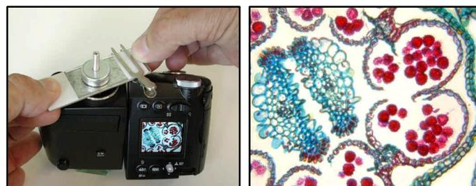
Abb. 2 Mikrofotografie des Testpräparats mit der Digitalkamera Coolpix 4500 (opt. Tele:  $f = 32 \text{ mm}$ )
